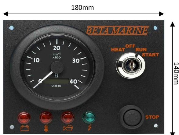
Tachymètre avec horamètre, interrupteur à clé, bouton poussoir d'arrêt, voyant de marche, alarme visuelle et sonore en cas de baisse de charge, de pression d'huile et de surchauffe ; 3m de câble de connexion avec la connectique.
